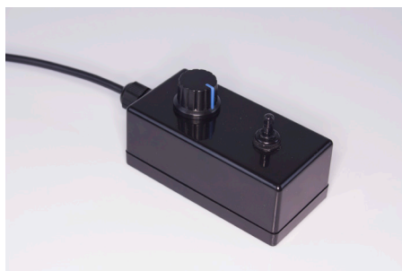
Рис. 2. Назначение кнопок: 1 – Тумблер (on-of-on), 2 – Ручка «Скорость»
